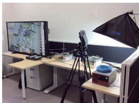
GI型POFによる4K非圧縮映像伝送実験デモンストレーション
