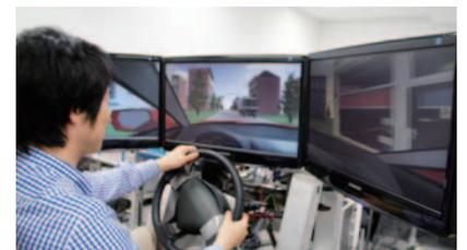
図1: ドライビングシミュレータ
