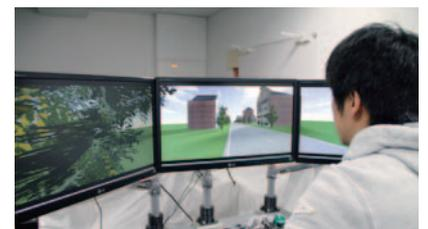
図2: バイクシミュレータ
