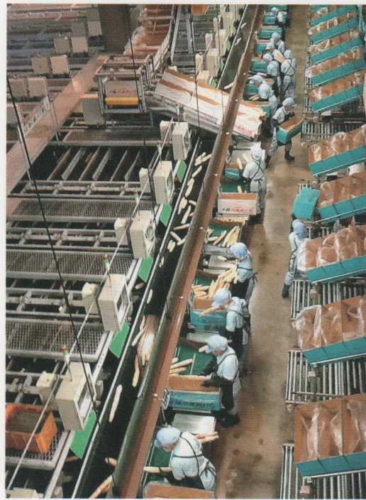
年間2万tの長イモがセンサーによって自動的に選別される
