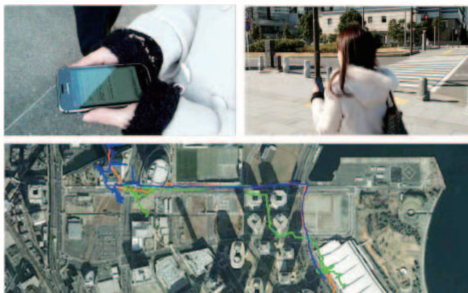
図3 準天頂衛星からの防災情報による被験者の避難とその移動履歴
