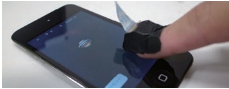
爪上のカメラにより、指下からの透過光を計測し指の押下力と姿勢を推定する試作システム
