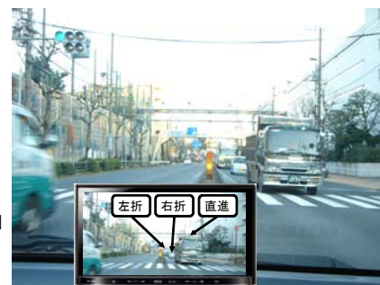
右折時対向車両情報表示システム: 自動車の進行方向意思情報をARで表示することで、運転手は右折時の正しい判断を行うことができます。
