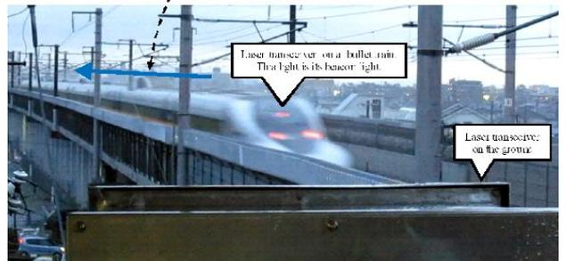
2010年に行った時速270キロで走行する新幹線車両と地上間の毎秒約1ギガビット超高速通信の実験
