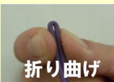
世界最速全フッ素化屈折率分布型プラスチック光ファイバ (GI POF)
